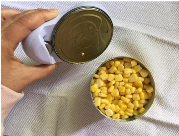
Une fois que la roue de découpe est réinitialisée et que le moteur est éteint, retirer le couvercle de la boîte. L'aimant permet de soulever le couvercle avec l'ouvre-boîte.
